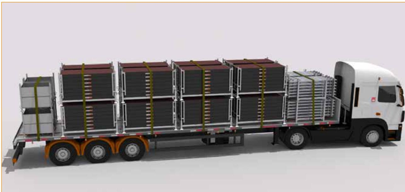
Exemplo de carregamento de um camião com 230 m<sup>2</sup> de cofragem HorizontAL compreendendo:
