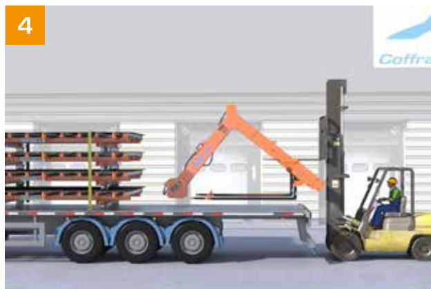
4 ...pour charger par l'arrière du camion.
