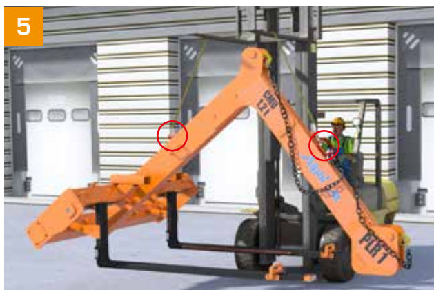
5 Deuxième méthode de chargement : avec une sangle certifiée 2T - Accrocher la sangle sur les points de levage spécifiques.
