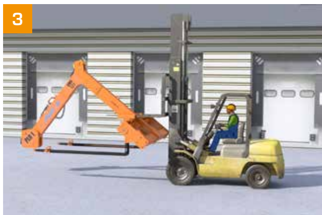
3 Première méthode de chargement : par les fourreaux...
