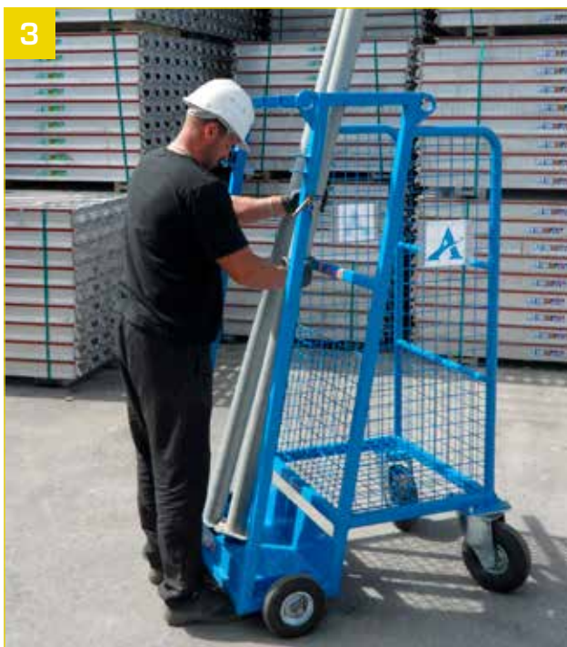
- Positionnement des étais dans le chariot.
