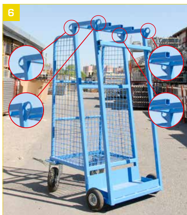
- Élingage : 4 crochets permettent la manutention du chariot, avec ses étais, par la grue
