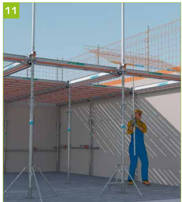
11 - A partir da superfície de trabalho, levantar simplesmente a rede AlphiSafe, com a ajuda da vara AlphiSafe.
