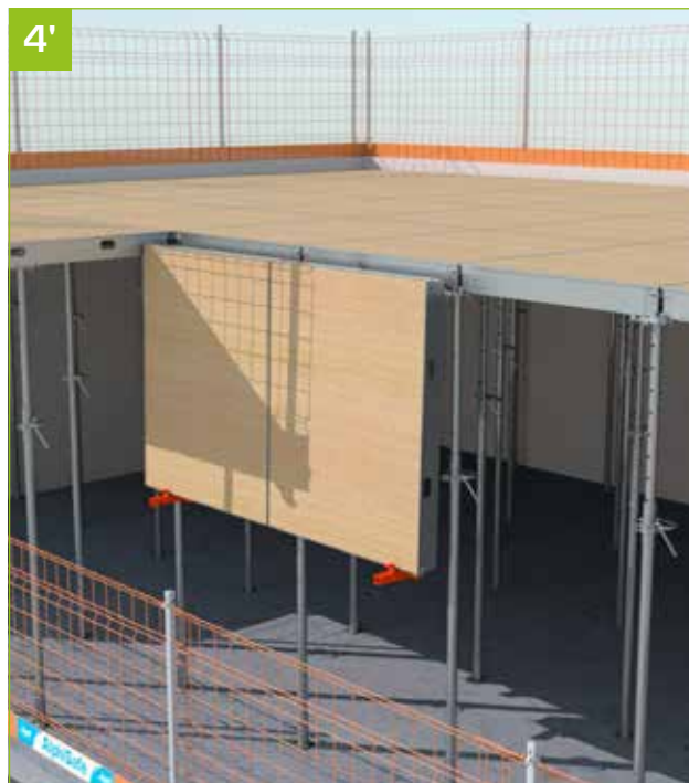
4' - Auf der Rückseite der Paneele jeweils am Rand 2 AlphiSafe-Adapter für MaxiDalle befestigen.
