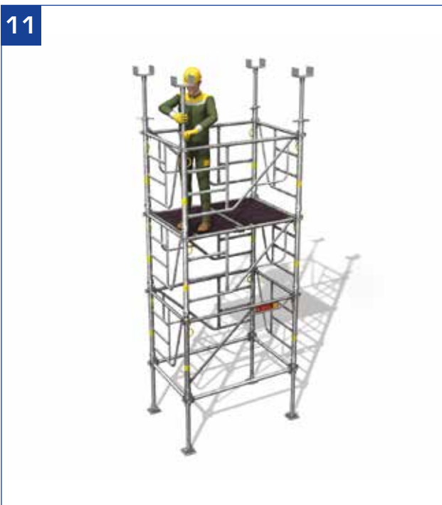
- Montagem e regulação dos cilindros de topo.
