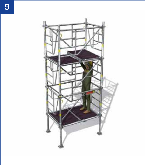
- Deslocação da 2.ª plataforma com alçapão, a partir do nível inferior.
