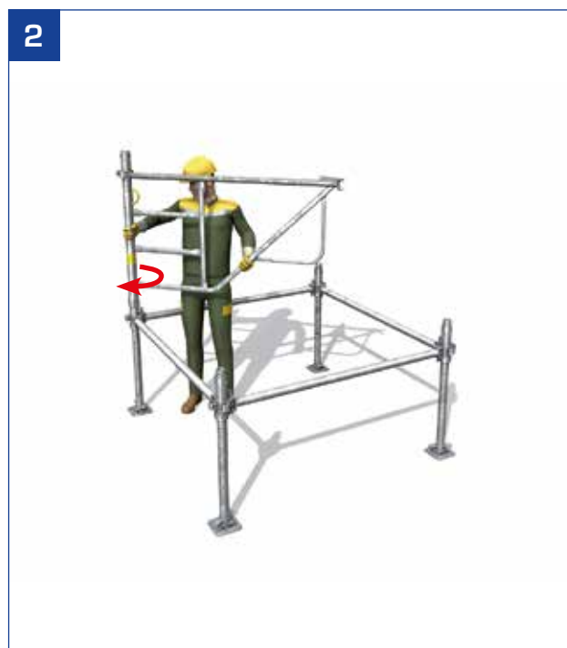
- A partir do interior da torre, montagem do 1.º módulo no eixo da diagonal, seguida de rotação para o prender.
