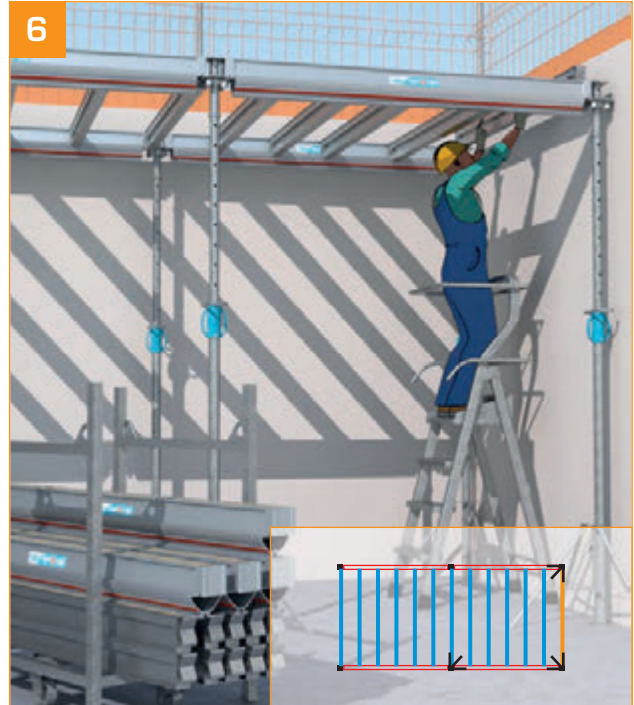
- Concluir a montagem das vigotas secundárias.
