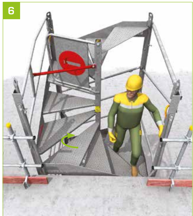
- Vor dem Lösen der Anschlagmittel sicherstellen, dass die Verankerungen angebracht sind. - Aufklappen der Geländer, um den Ausstieg auf der gewünschten Ebene zu ermöglichen.
