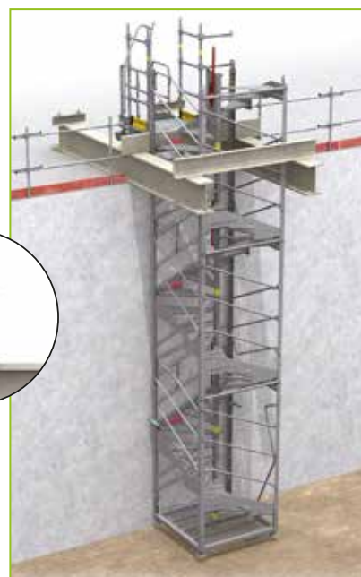
- Schéma d'un EscAlphi MDS suspendu pour accéder au fond de fouille.
