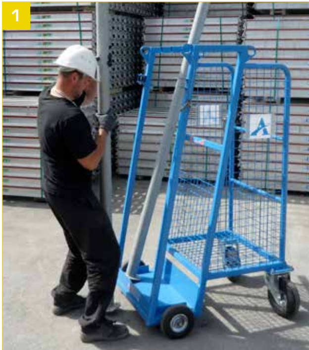
- Antransport der Stützen in aufrechter Position.
