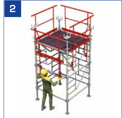
2 - Einsetzen der 4 Sicherheitsgeländer von der Turmaußenseite aus (Turmhöhe ≤ 2 Rahmen).
