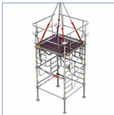
7 - Krantransport: planen Sie vier zusätzliche Schlingen ein, um das Einhängen vom Belag aus zu erleichtern.
