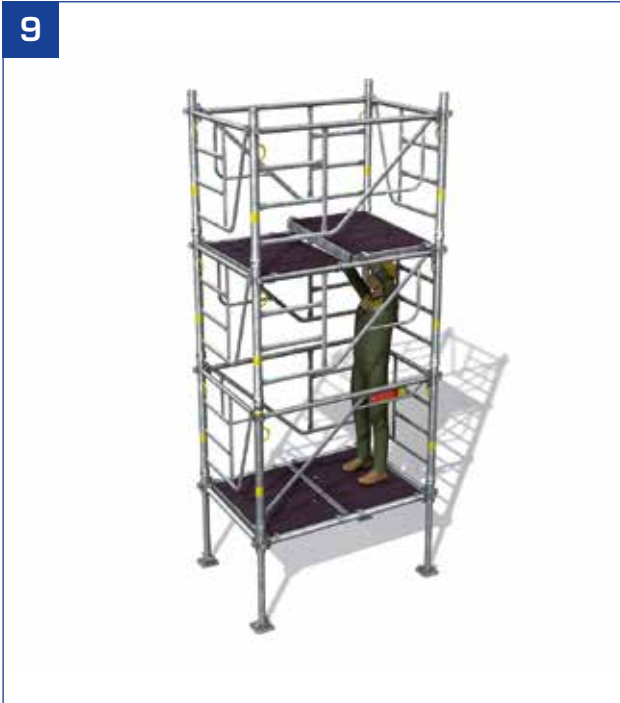
- Versetzen des zweiten Durchstiegselements von der unteren Ebene aus.
