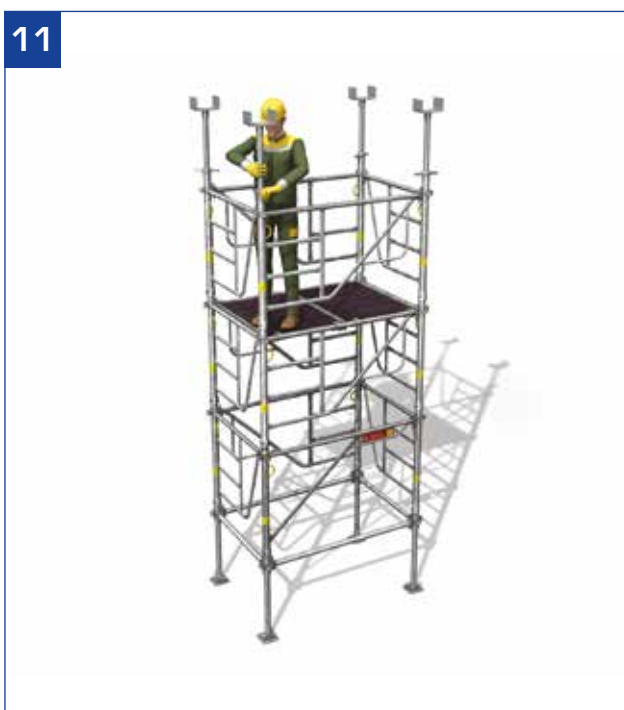
- Mise en place et réglage des vérins de tête.
