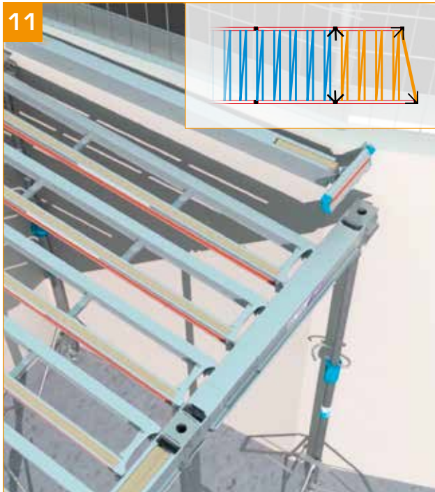
- Den Nebenträger für Verlegung im Winkel anbringen.
