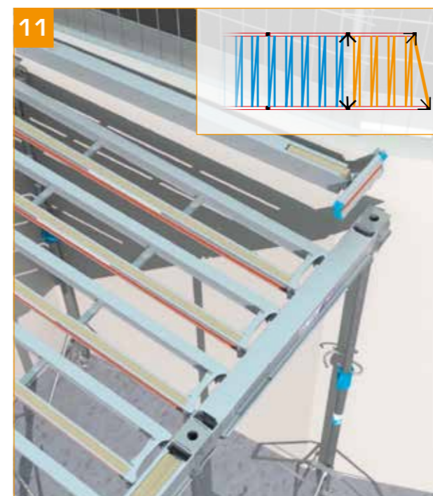
- Montagem da vigota secundária extensível angular.
